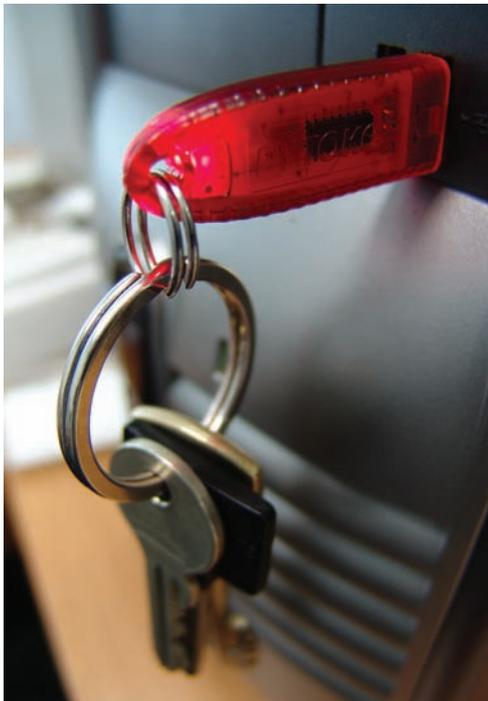
Рутокен — универсальное устройство, предназначенное для решения широкого круга задач: программно-аппаратная аутентификация при подключении к сети; защищенные соединения при доступе к базам данных и web-ресурсам; криптографическая защита информации; разграничение доступа к компьютеру; защита электронной переписки; хранение и использование ЭЦП в системах юридически значимого документооборота.
